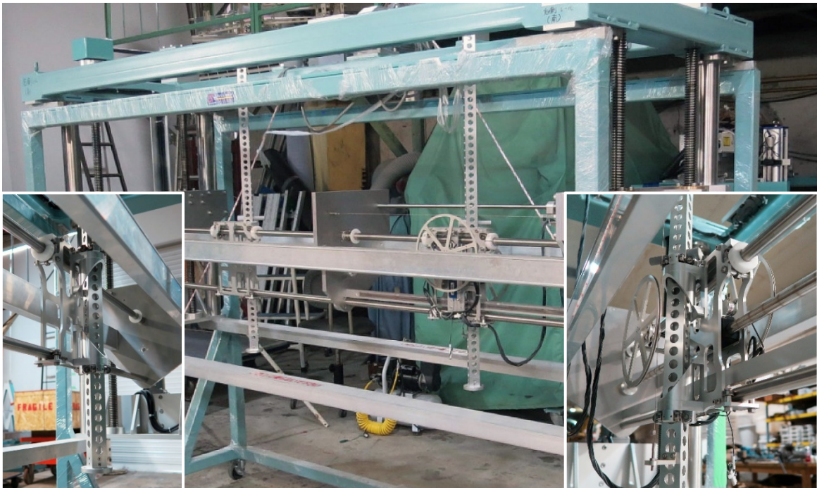
Fig. 16: 波浪中抵抗増加・船体運動計測装置(左右の拡大写真は前後のロッドとガイド部分)
