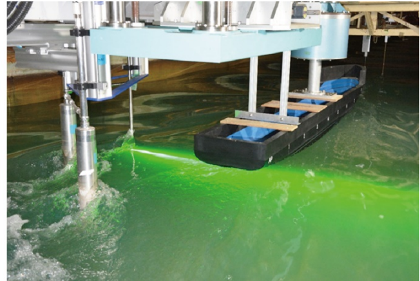
Fig. 2: 三井造船昭島研究所小水槽での計測
