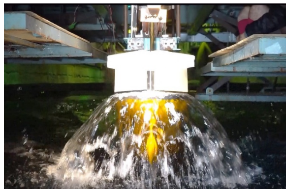
Fig. 12: 大振幅波浪中での非線形船体運動
