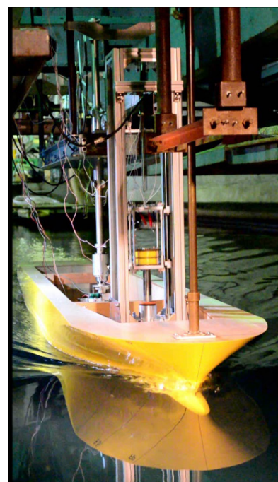
Fig. 10: 船舶搭載型発電装置による船体の運動エネルギー回収に関する研究
