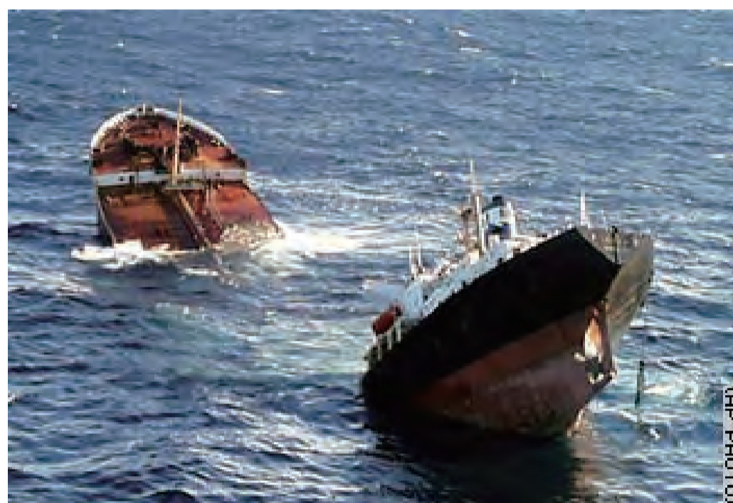
船の大規模な構造崩壊事故の例
