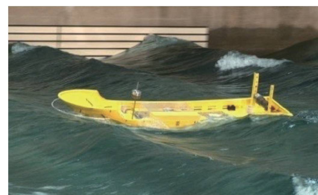
自由航走模型実験による安全性評価
