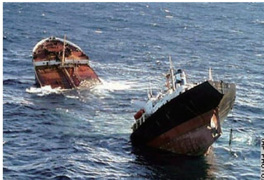
船の大規模な構造崩壊事故の例
