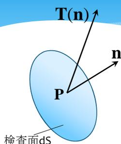
左図のように点Pを通る微小部分  $dS$  を通して  $S$  の内側から外側に作用する面積力を  $T(\mathbf{n})dS$  とするとき、 $T(\mathbf{n})$  を **応力テンソル** と呼ぶ。
