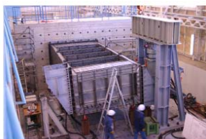
長さ8m, 幅3m, 深さ2mのコンテナ船大型模型の崩壊試験とコンピュータシミュレーション
