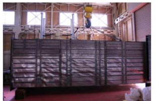
長さ8m, 幅3m, 深さ2mのコンテナ船大型模型の崩壊試験とコンピュータシミュレーション
